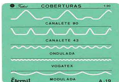
Figura 41: Gabarito de telha Fonte: o projetista (2012)
