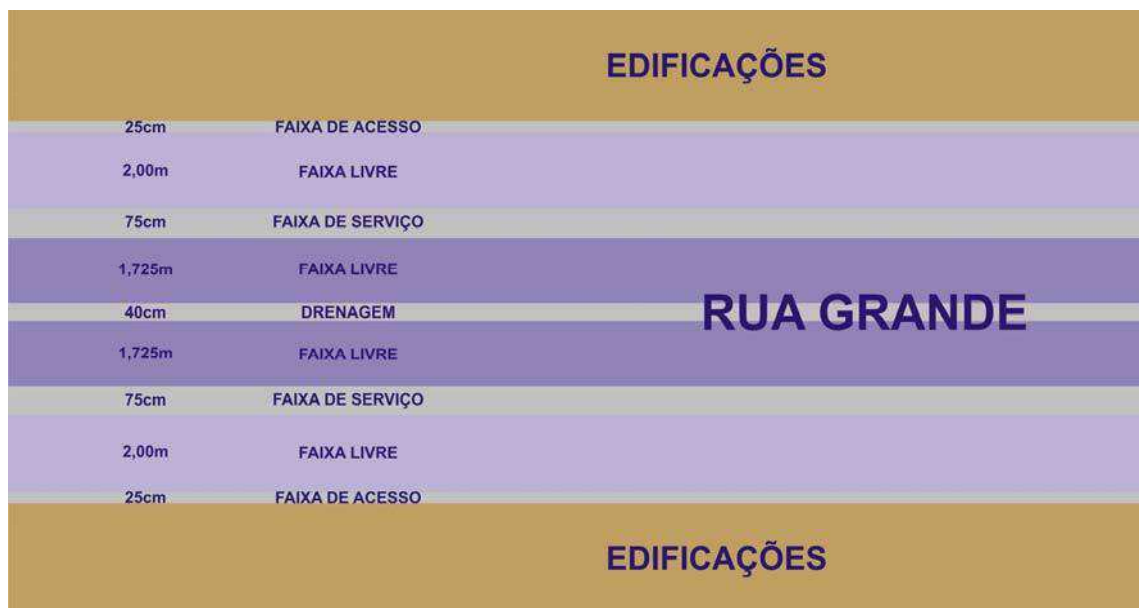
Figura 6.24. Rua Grande: proposta da dimensão das faixas de acesso, livre, de serviço e da drenagem. Projeto para a largura média de 10 metros.
