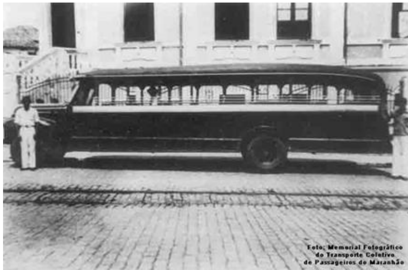
Figura 5.2. Ônibus Ford em São Luís, anos 40. Foi construído por um fabricante local sobre um chassi Ford 1942. A carroceria era em madeira, e, por causa de seu grande comprimento e capacidade, era conhecido como “gigantão”.
