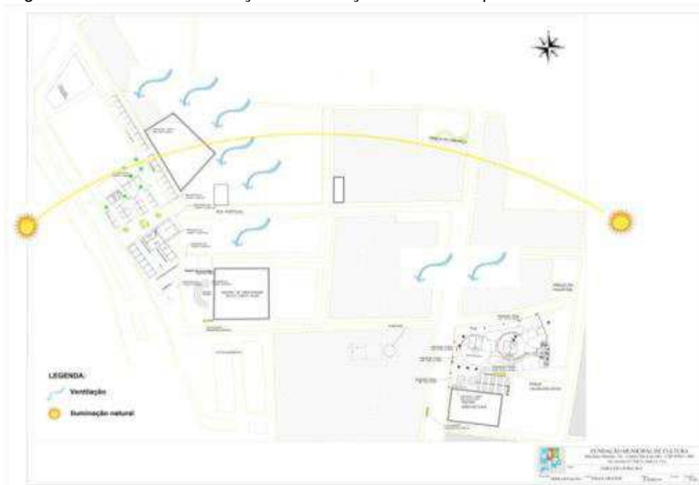
Figura 55 - Estudo de ventilação e iluminação naturais na planta baixa da FeliS-2016.
