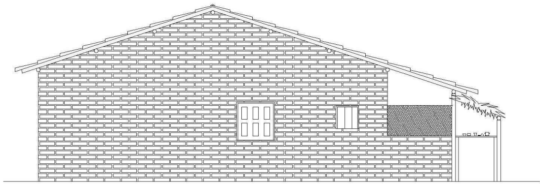
Figura 47: Fachada lateral direita da casa em adobe de D. Naidles. Fonte: LATESE, 2017.
