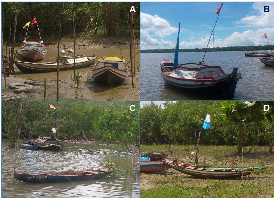
Figura 12: Embarcações do Porto do Quebra-Pote: 12A) Biana com motor; 12B) Biana a pano; 12C) Casquinho; 12D) Canoas a pano. Fonte: Elaborado pela autora, 2017.
