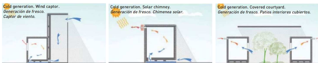
Figura 38 – Técnicas de conforto térmico em contêiner para geração de frio
