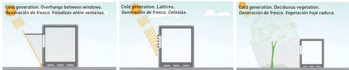
Figura 35 – Técnicas de conforto térmico em contêiner para geração de frio
