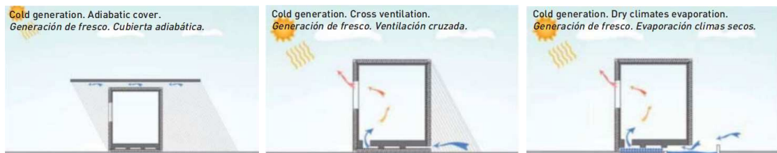
Figura 37 – Técnicas de conforto térmico em contêiner para geração de frio
