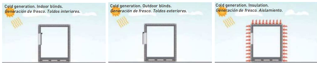
Figura 36 – Técnicas de conforto térmico em contêiner para geração de frio
