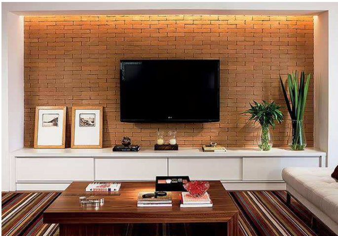
Foto 16 - Iluminação indireta por lâmpadas embutidas
