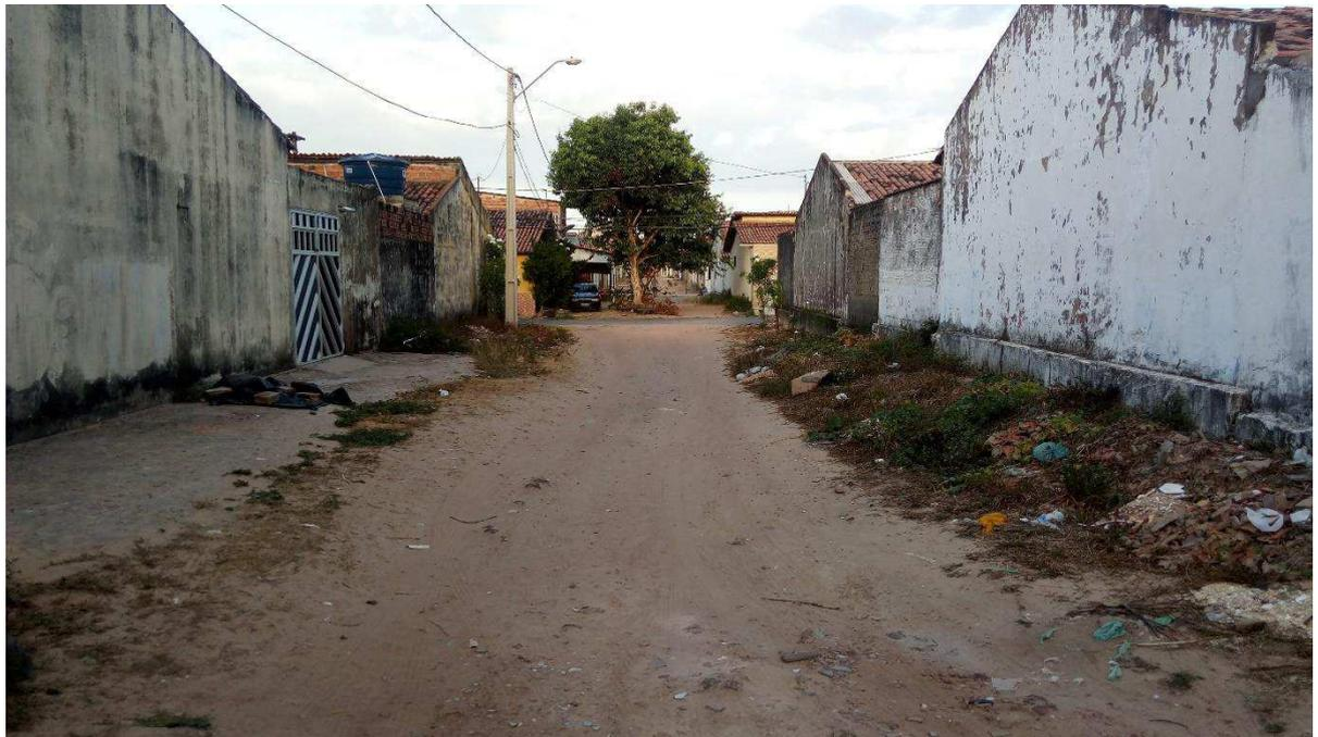
**DESCRIÇÃO:** Inexistência de passeio do lado direito da via, devido ao acúmulo de vegetação e lixo. Ausência de rampas de acesso no passeio do lado esquerdo da via (conforme o item 6.12.7.3 da NBR 9050).
