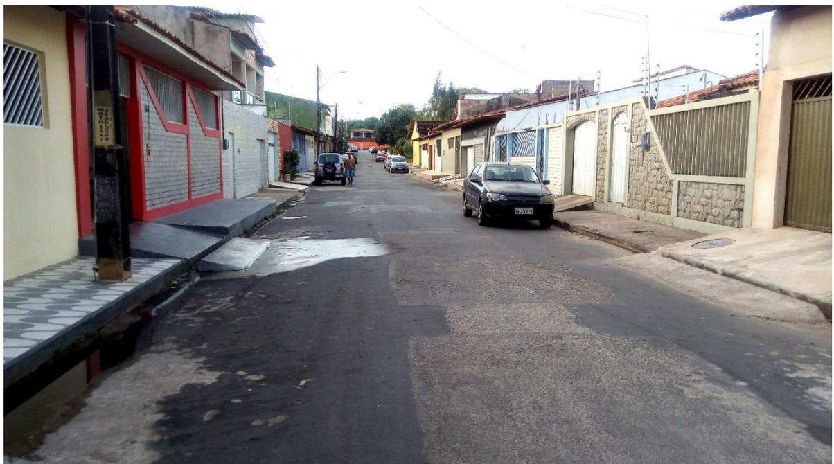
**DESCRIÇÃO:** Pavimentação irregular, com a presença de desníveis acentuados, sem sinalização adequada (conforme o item 5.4.6 da NBR 9050), podendo causar acidentes. Rampas e postes implantados na calçada atuando como barreira física.
