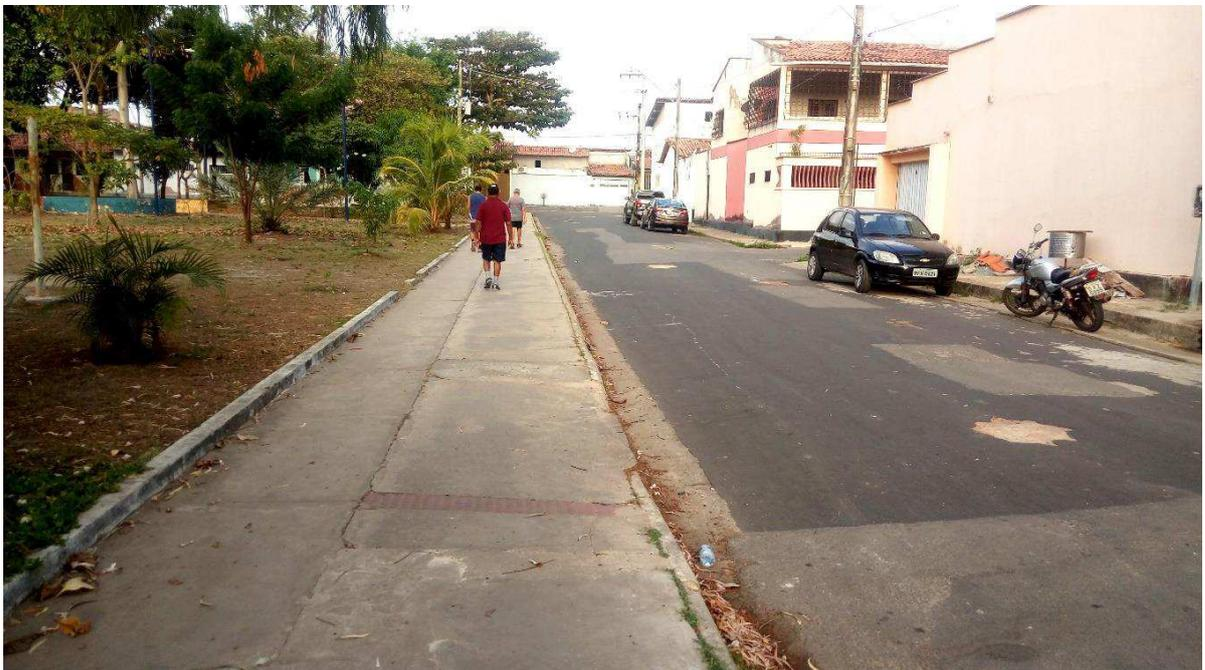
**DESCRIÇÃO:** Pavimentação irregular, sem sinalização adequada (conforme o item 5.4.6 da NBR 9050). Rampa com sinalização tátil aplicada inadequadamente (contradizendo o item 6.12.7.3 da NBR 9050).
