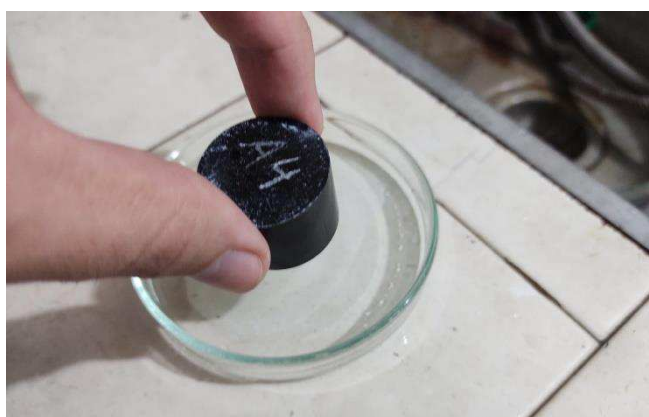
Figura 3.16 – Amostra sendo imersa em nital 2% (Autor, 2021).
