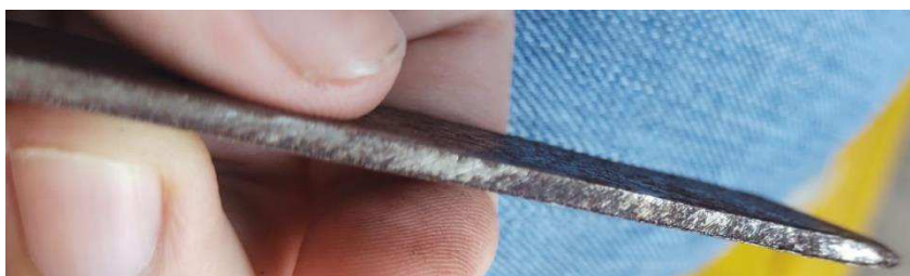
Figura 3.8 – Face interna ao corte a jato de água abrasivo a olho nu (Autor, 2021).
