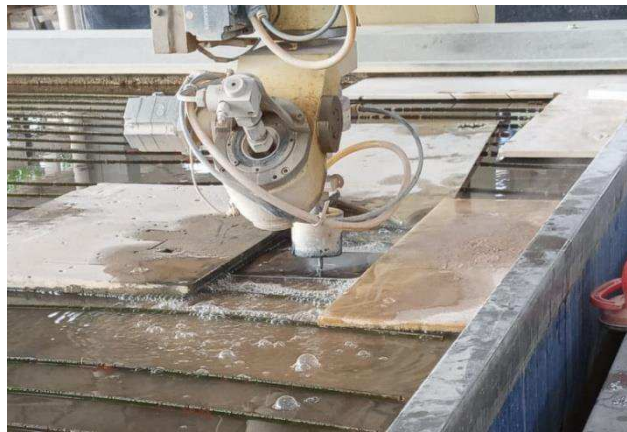
Figura 3.6 – Processo de corte a jato de água abrasivo (Autor, 2021).
