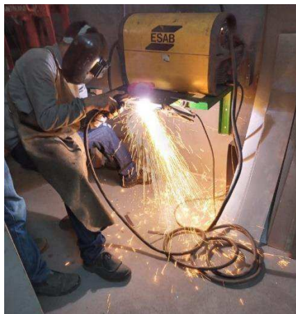
Figura 3.4 – Processo de corte a plasma (Autor, 2021).
