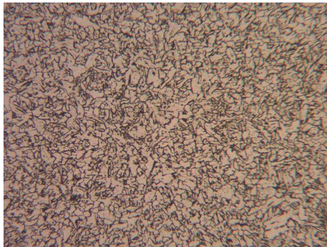
Figura 4.1 – Microestrutura de base do aço A36 com aumento de 100x (Autor, 2021).
