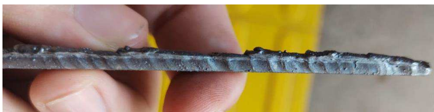
Figura 3.9 – Face interna ao corte a plasma a olho nu (Autor, 2021).
