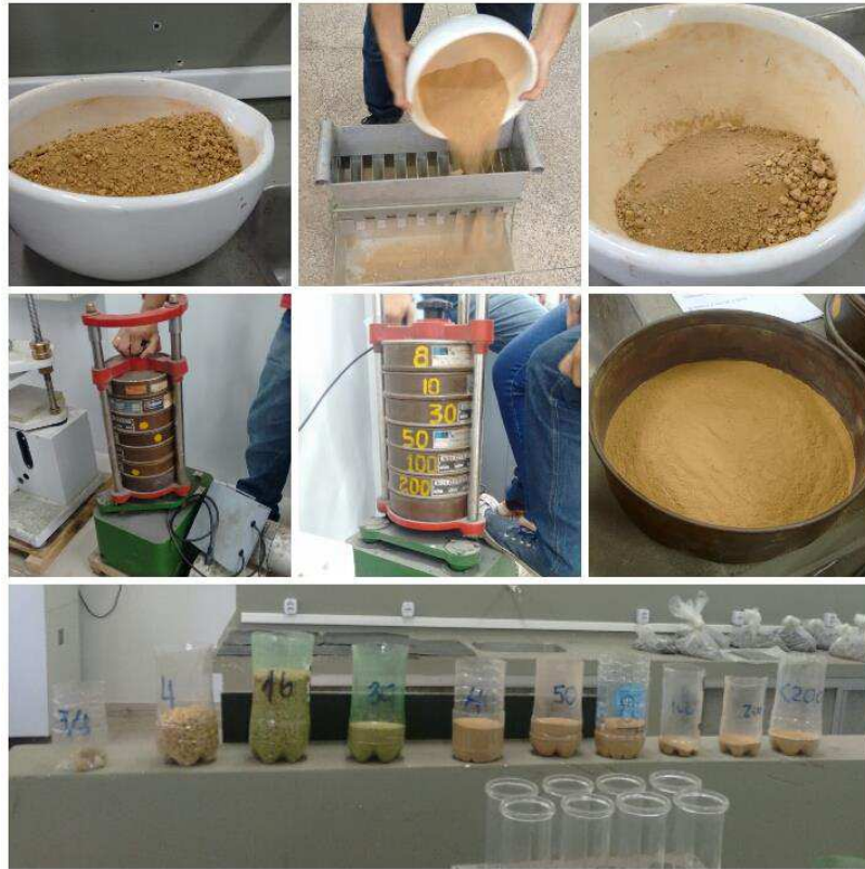
Figura 45: Ensaio de peneiramento- série de peneiras padronizadas e aparelho elétrico de peneiramento. Fonte: Acervo da autora (LIMA, 2016).
