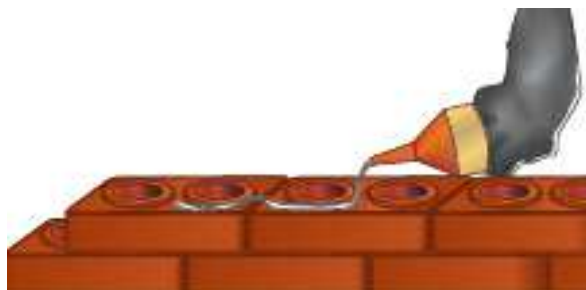
Figura 22: Assentamento dos tijolos de solo-cimento.
