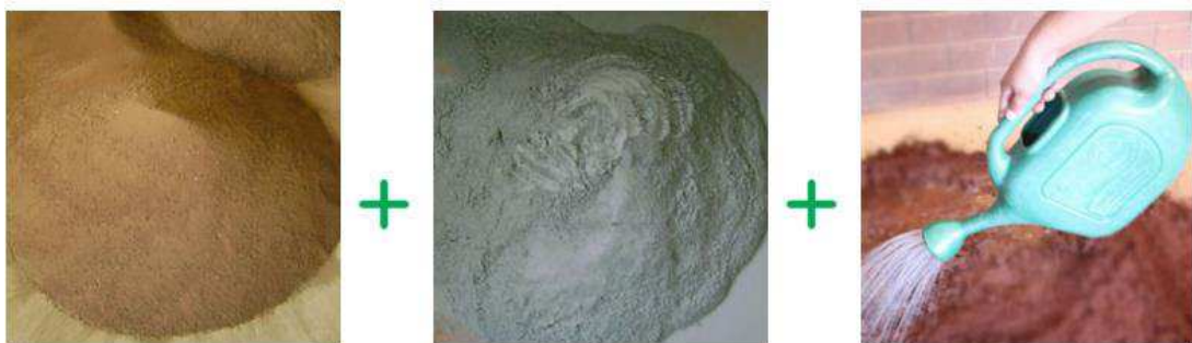
Figura 16: Mistura dos componentes (solo, cimento e água) Fonte: http://ecomaquinas.com.br/tijolo-ecologico-como-produzir
