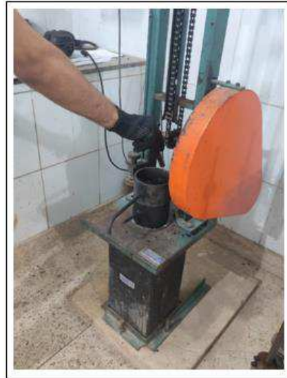
Figura 43 - Golpes para acomodação
