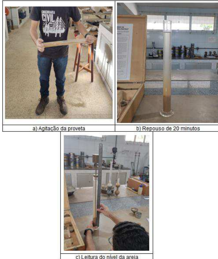
Figura 26 – (a) – (c) Sequência do ensaio de Equivalente de Areia
