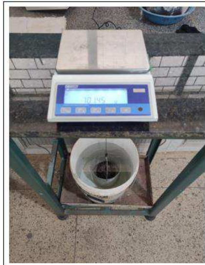
Figura 48 - Pesagem hidrostática do CP
