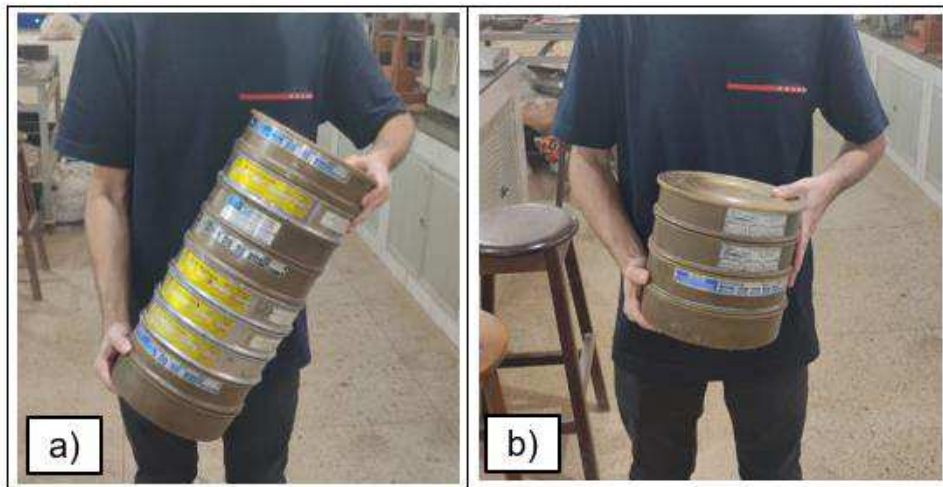
Figura 30 – a) Peneiramento do agregado graúdo; b) Peneiramento do agregado miúdo
