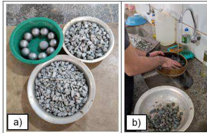
Figura 23 – a) Separação dos materiais; b) Lavagem do material na peneira nº 12
