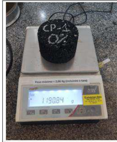
Figura 47 - Determinação da massa do CP seco
