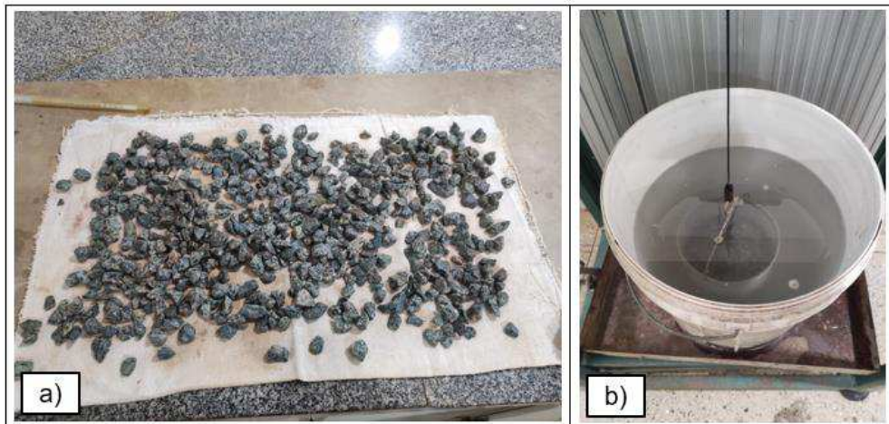
Figura 21 – a) Eliminação das películas visíveis de água; b) Pesagem hidrostática
