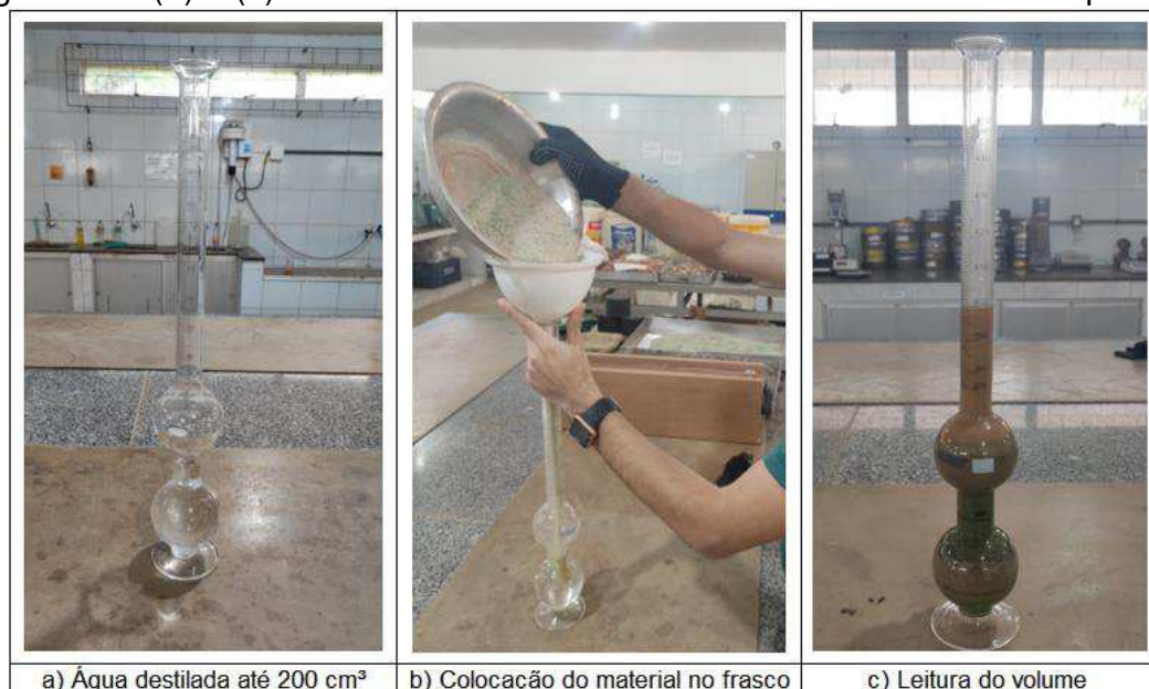
Figura 28 – (a) – (c) Procedimentos executados no ensaio de massa específica
