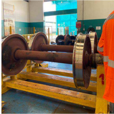
Figura 33: Rodeiro posicionado para Ultrassom
