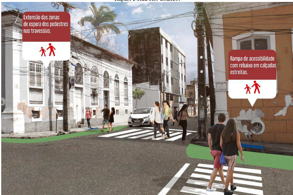
Figura 45 - Representação ilustrativa da ampliação das zonas de espera nos cruzamentos das ruas Barão de Itapari e Rua Rio Branco.
