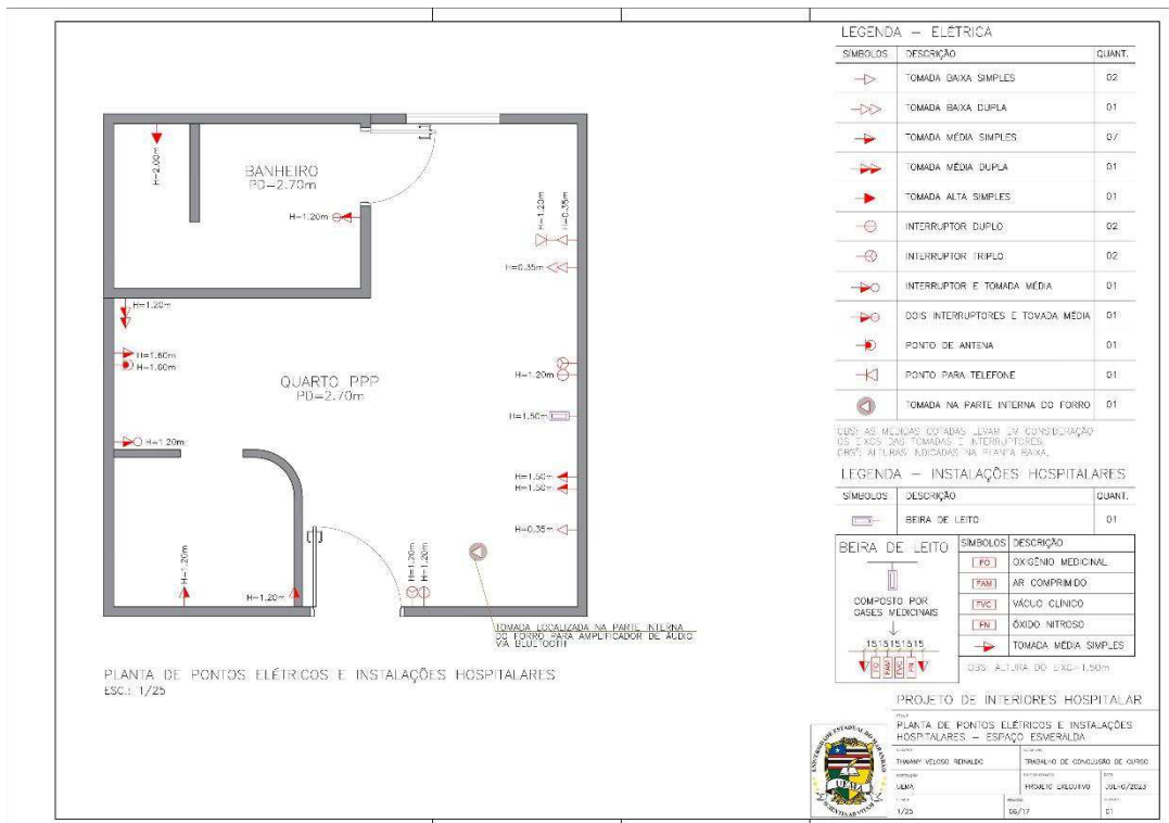
Figura 28 - Planta de Pontos Elétricos e Instalações Hospitalares
