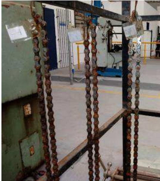
Figura 5.3 - Correntes oxidadas após 10 dias de exposição ao ambiente
