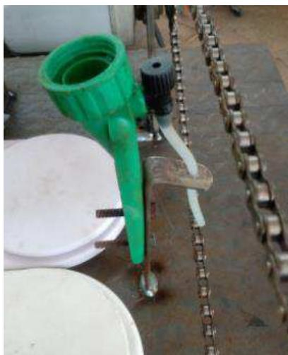
Figura 3.10 - Suporte para reservat rio do lubrificante e mangueira com o controlador de vaz o.
