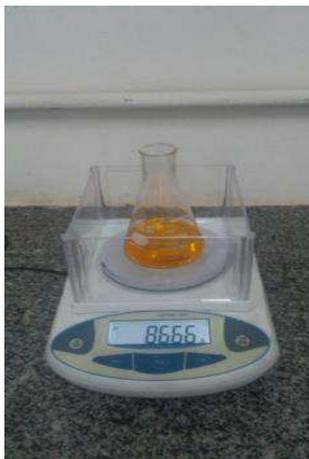
Figura 3.1 - Balança de precisão e Erlenmeyer.
