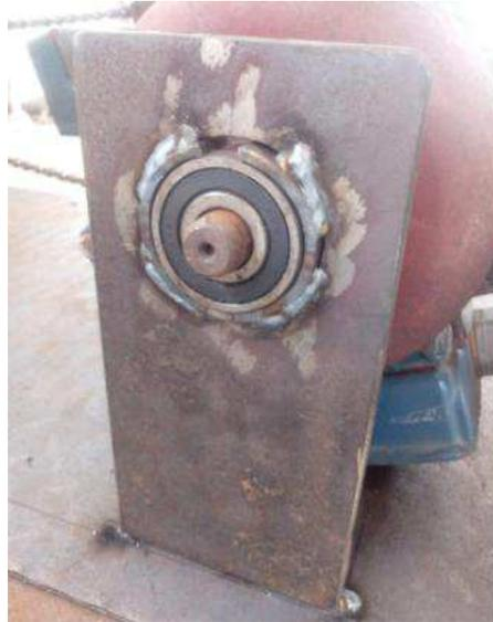
Figura 3.9 - Eixo do motor acoplado ao rolamento.
