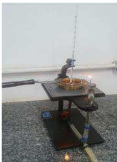
Figura 3.4 – Ensaio de ponto de fulgor utilizando vaso aberto de Cleveland.
