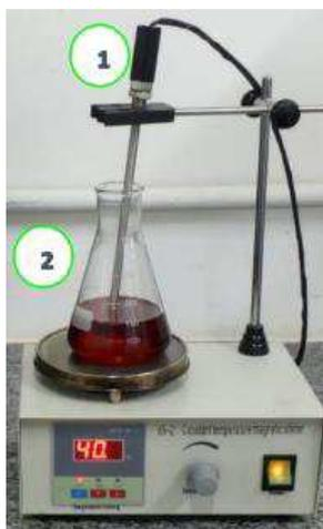
Figura 3.3 - Agitador magnético: 1 - Medidor de temperatura; 2 - Recipiente com ímã de agitação.
