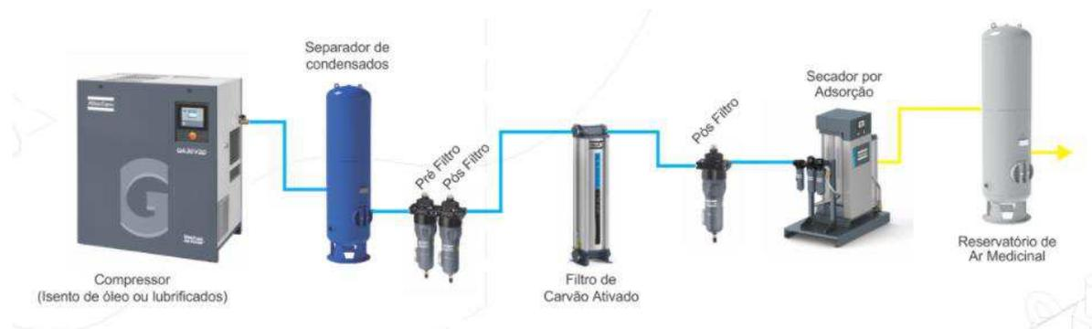
Figura 2.1 - Esquema de instalação para uma central de ar comprimido.
