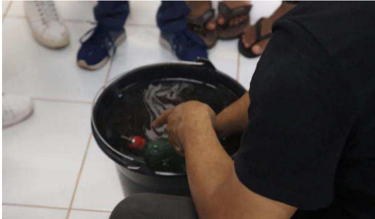
Figura 54 – Verificação de vazamento.
