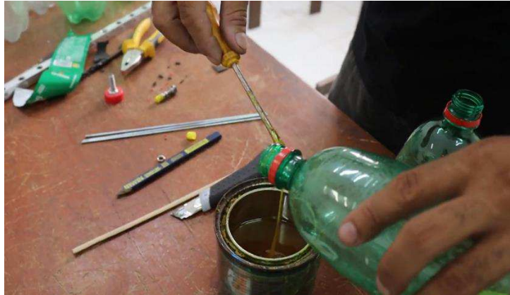
Figura 56 –Passagem de cola.
