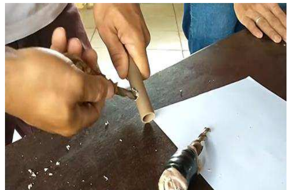
Figura 43 – Finalização com a broca
