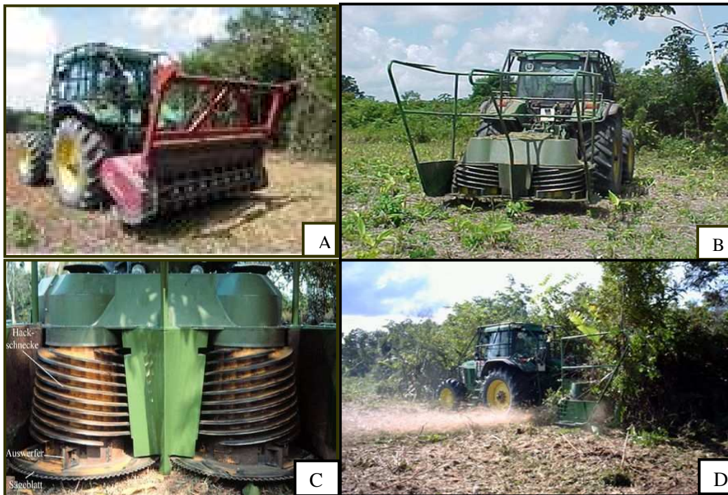
Figura 1.1. Awhi FM600 (A) (Fonte: < http://www.embrapa.gov.br/ >); Tritucap (B); Serras circulares e hélices (facas helicoidais) (C), trituração de capoeira com tritucap (D): (Fonte: < http://www.uni-goettingen.de/de/86458.html >).
