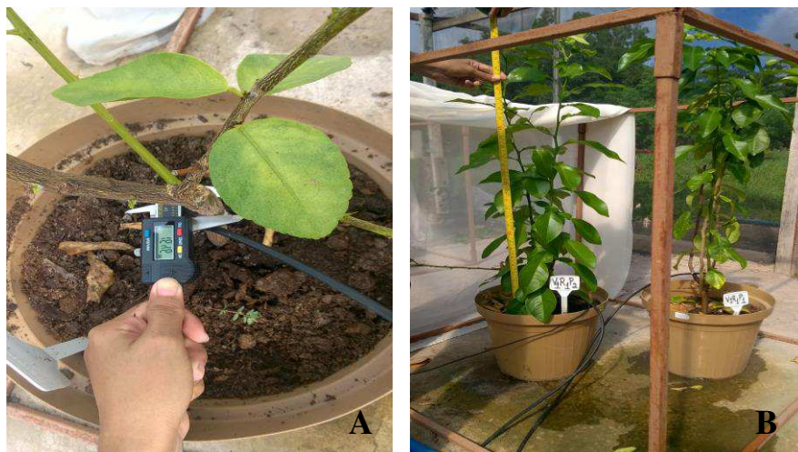
Figura 4. Paquímetro (A) e trena (B) utilizados para de terminação biométrica em variedades de citros em casa de vegetação. São Luís, MA, 2015.
