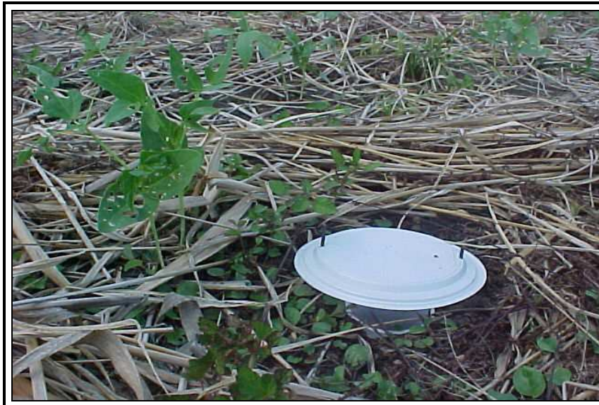
Figura 10. Armadilha pitfall com proteção contra chuvas. Miranda do norte (MA), 2004.
