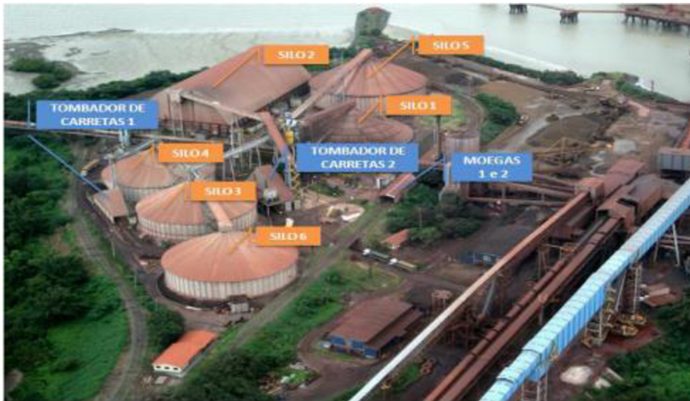
Figura 15 – Estrutura do terminal portuário
