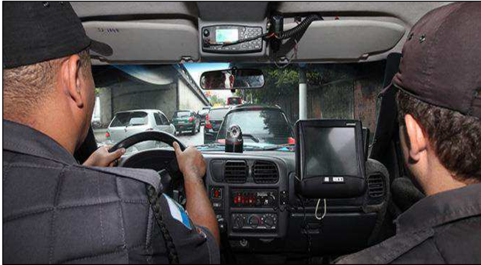
Figura 6 - Sistema de câmeras e captadores de áudio em viatura policial
