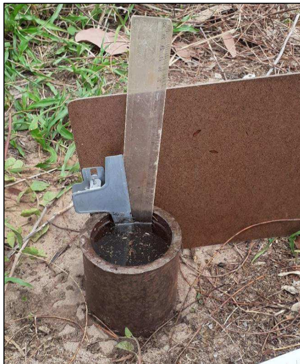
Figura 19 - Régua usada na medição de infiltração.
