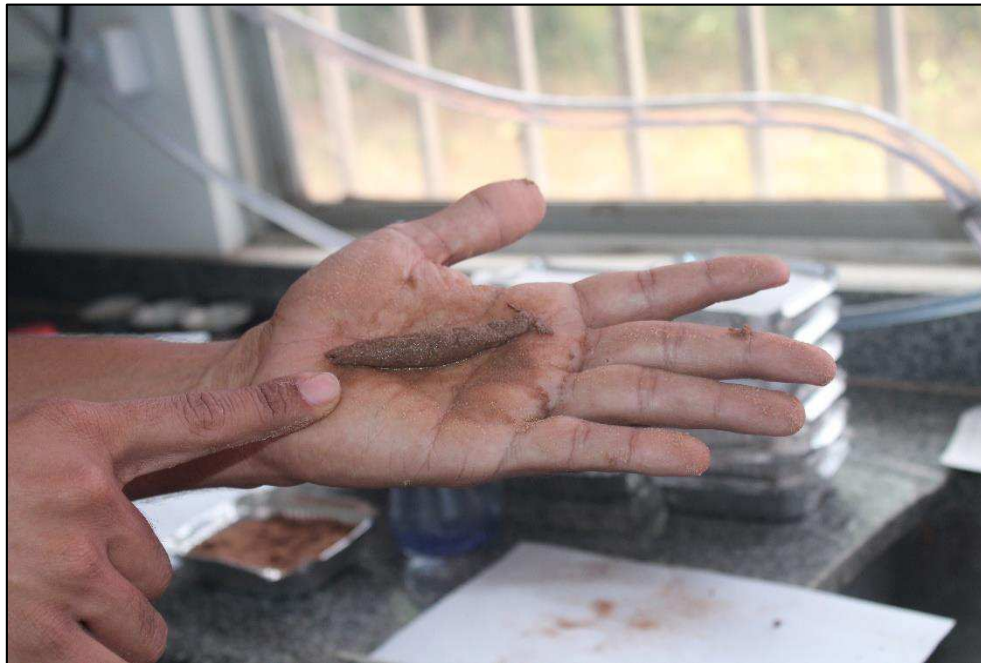
Figura 22 - Verificação da plasticidade da amostra.
