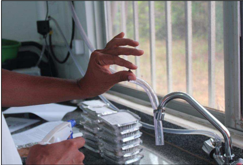
Figura 23 - Verificação da pegajosidade da amostra.
