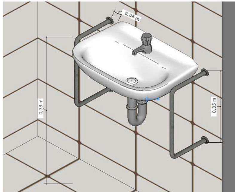
Figura 31: Barras de apoio C.
