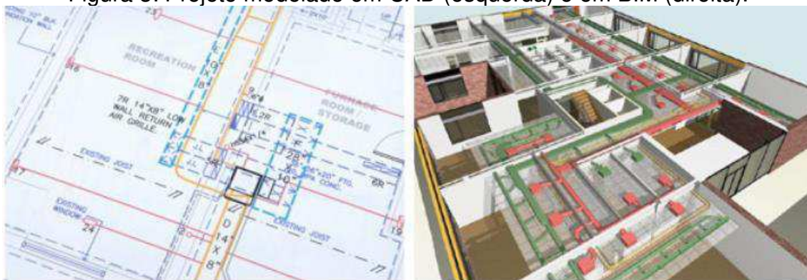
Figura 3: Projeto modelado em CAD (esquerda) e em BIM (direita).
