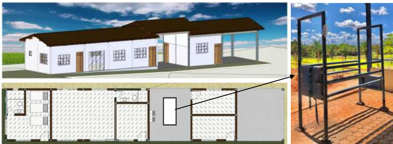
Figura 7: Modelo de instalações para a seção veterinária. (A) Vista da humanizada em 3D da fachada. (B) Planta baixa. (C) Brete para contenção e sua localização na planta.
