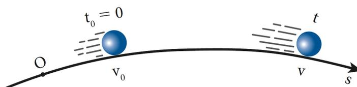
Figura 40 – Trajetória orientada de um móvel em movimento uniformemente variado.
