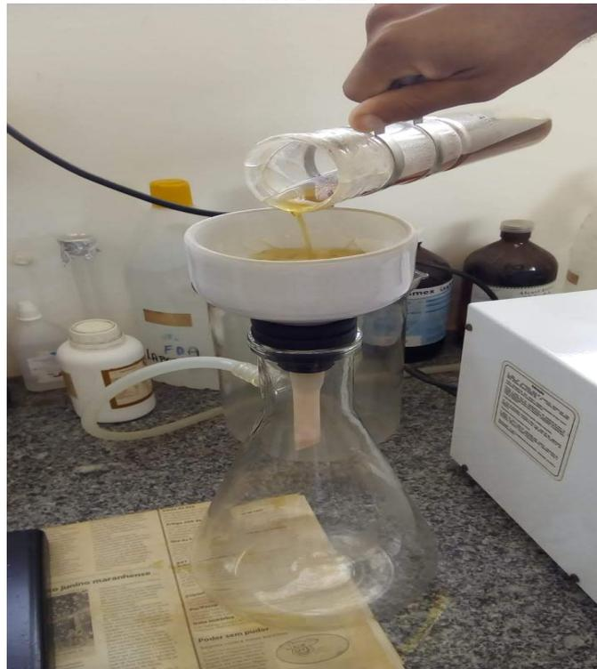
Figura 10: Processo de filtragem com bomba a vacuo.
