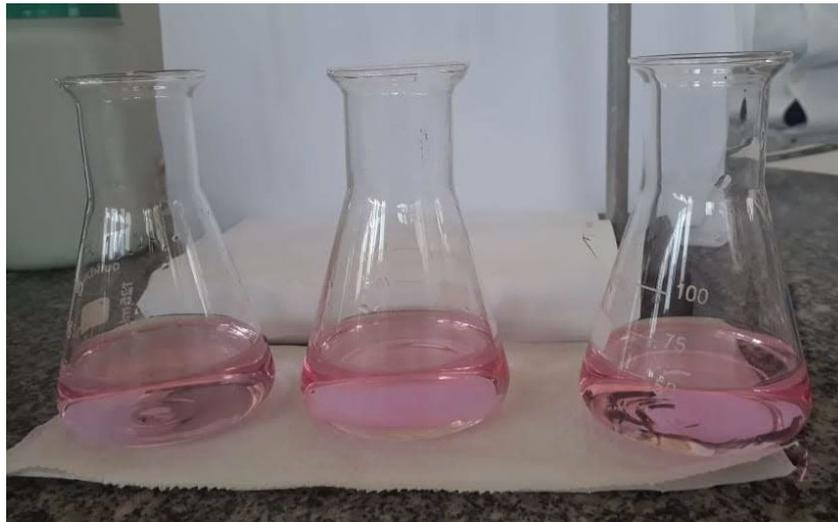
Figura 12: Erlenmeyer com solução receptora de ácido bórico.
