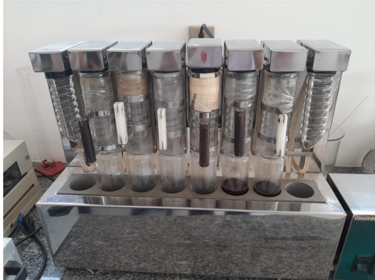
Figura 9: Bloco digestor de fibra.
