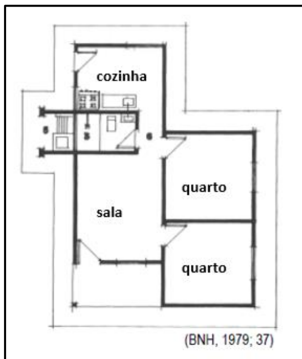
Figura 5 - Planta de casa em lote (10x25m) na cidade de São Luís, de acordo com padrões do BNH.
