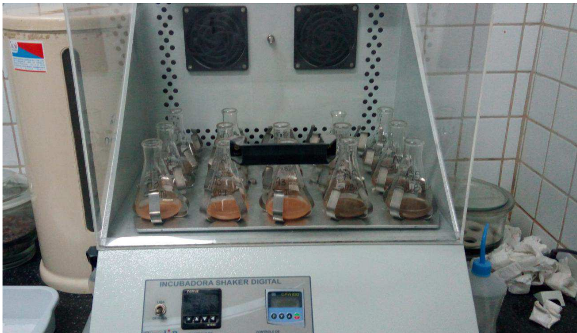
Figura 18 - Amostras de solo submetidas à agitação em mesa agitadora
