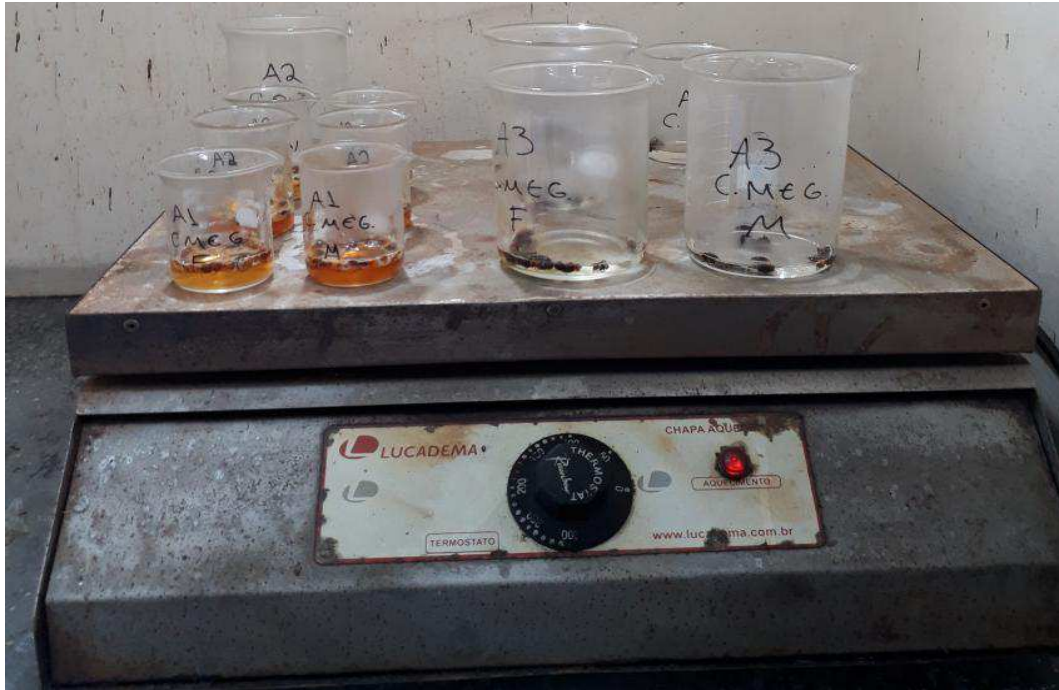
Figura 20 - Amostras de moscas sob digestão em placa de aquecimento a 90°C para extração de metais potencialmente tóxicos
