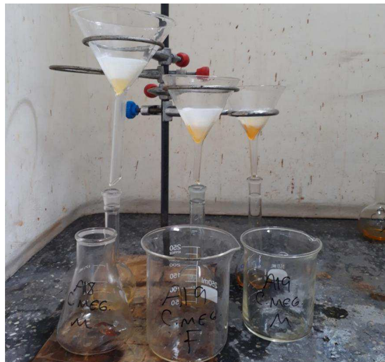
Figura 21 - Amostras de moscas sendo filtradas para extrair metais potencialmente tóxicos
