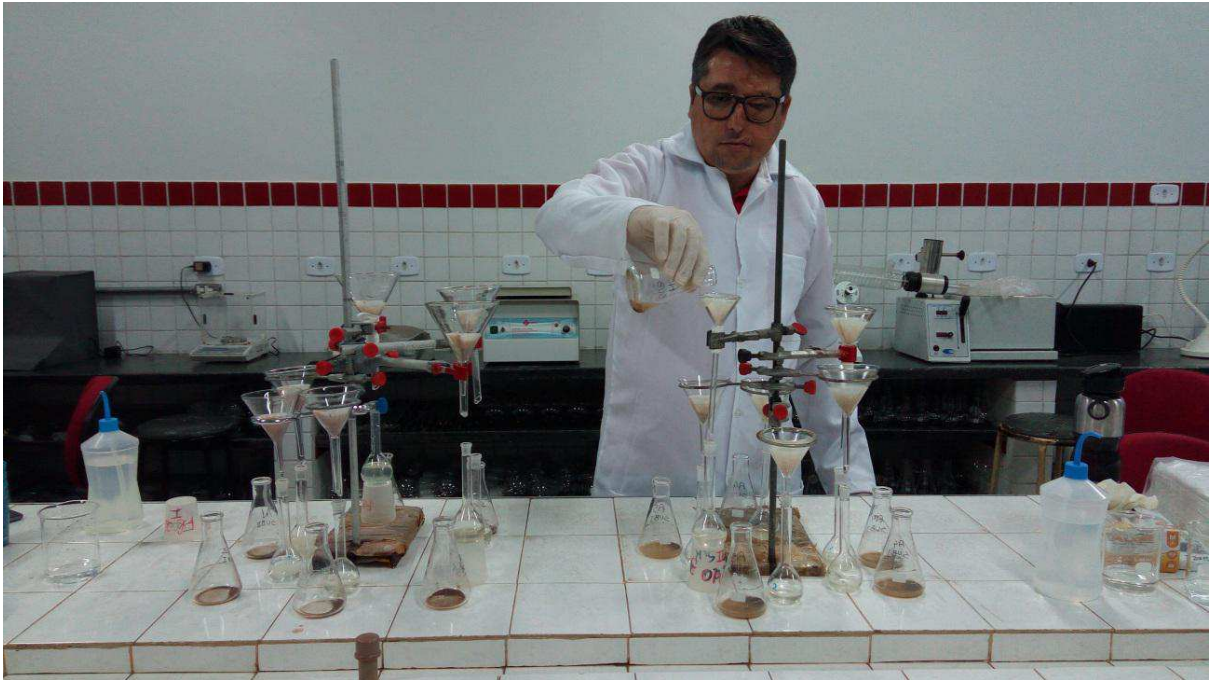
Figura 19 - Amostras de solo sendo filtradas
