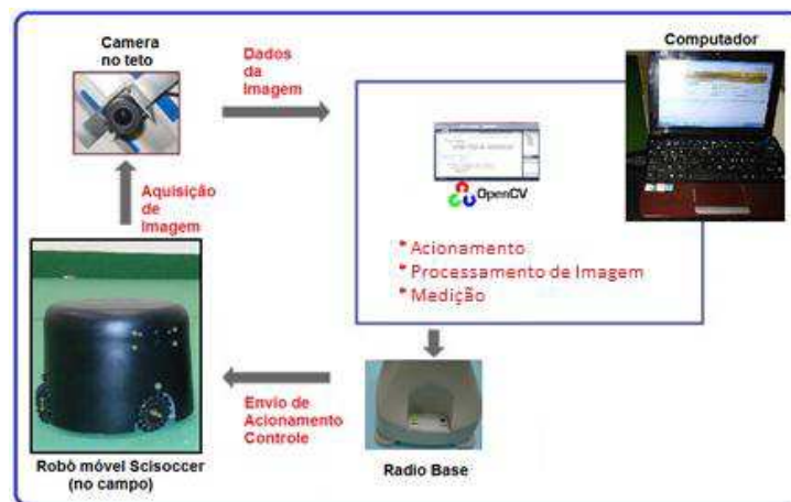
Figura 45. Estrutura geral do sistema
