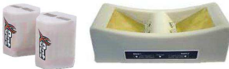
Figura 29. Baterias e recarregador da plataforma robótica
