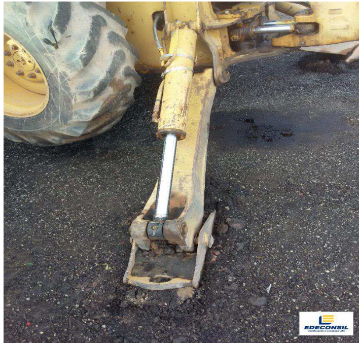
Figura 4.2 – Cilindro do estabilizador da 416D (Imagem cedida pela Edeconsil Construções e Locações LTDA, 2018)
