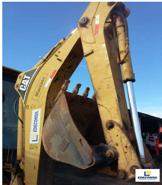
Figura 4.3 – Cilindro da Caçamba 416D (Imagem cedida pela Edeconsil Construções e Locações LTDA, 2018)
