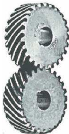
Figura 2-5: Par de engrenagens de hélices de lados opostos (adaptado de norton, 2013)
