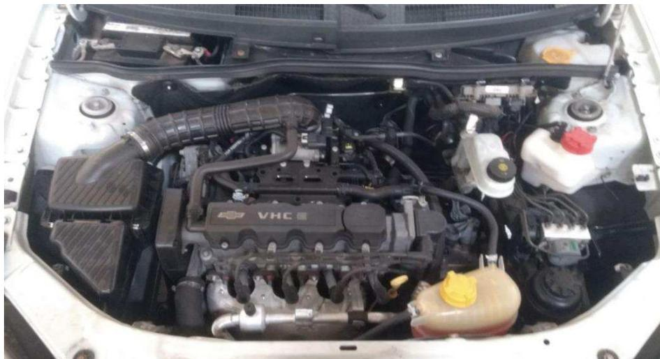
**Figura 4.1. Motor VHC-E original.**
