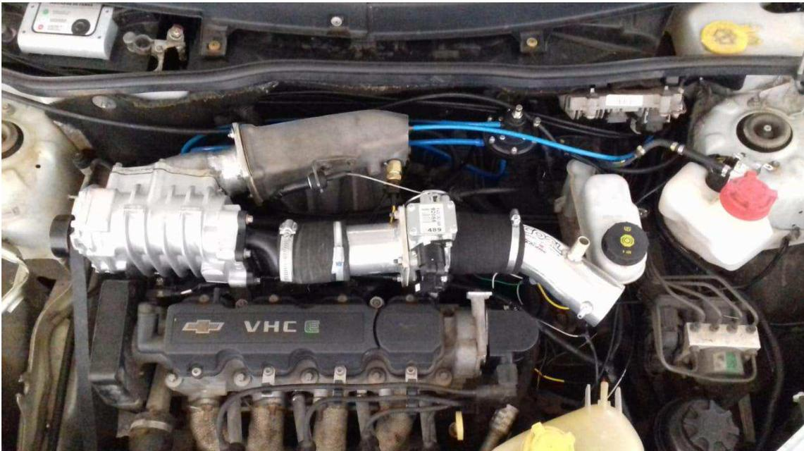
**Figura 5.4. Motor sobrealimentado com supercharger.**
