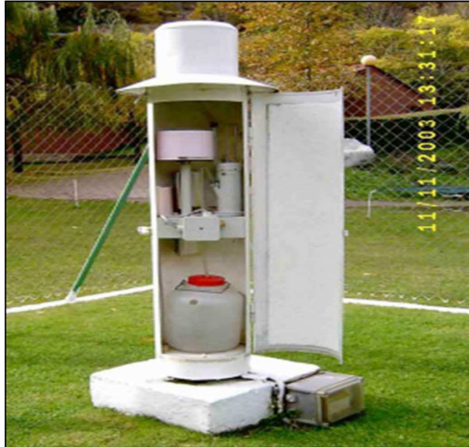
Figura 2 - Pluviômetro do tipo Sifão de Fuess
