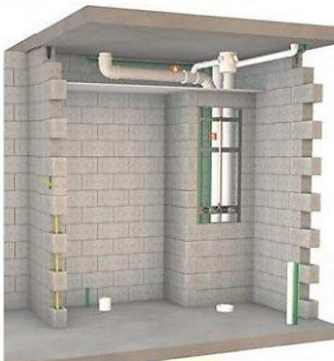
Figura 32: Tubulação de piso.
