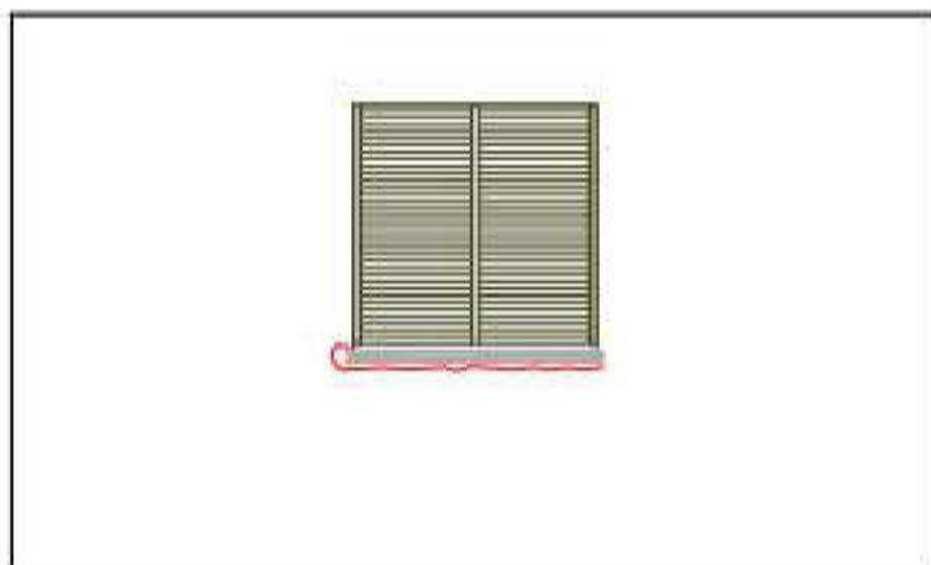
Figura 69: Fissura horizontal na interface peitoril/esquadria.
