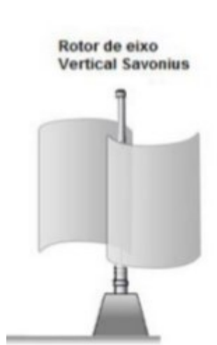
Figura 25 - Aerogerador eólico vertical tipo Savonius
