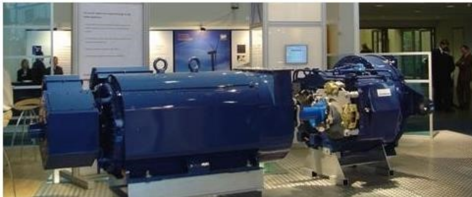
Figura 28 - Gerador e caixa de transmissão
