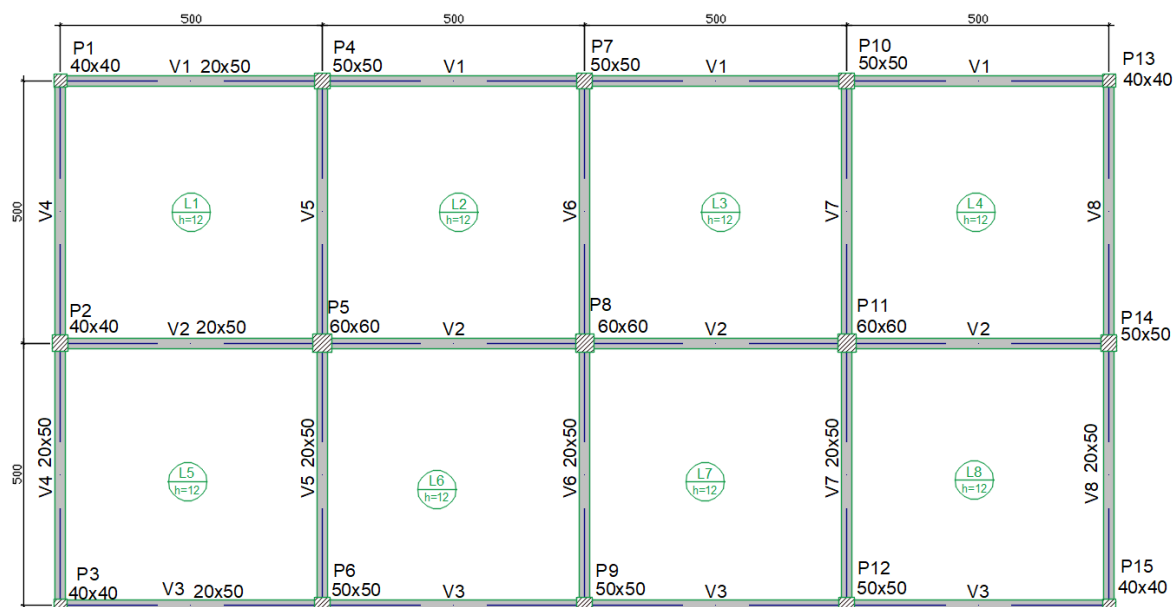
Figura 27 - Planta baixa para as edificações de 12 pavimentos.
