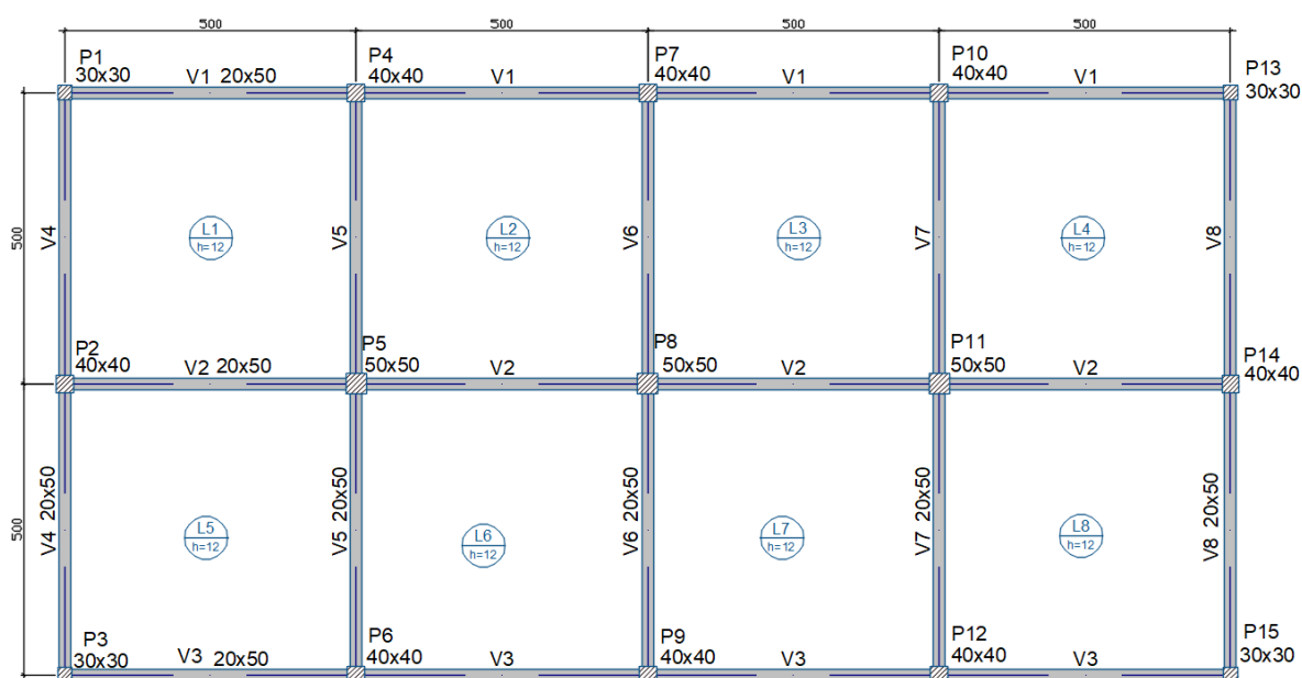
Figura 24 - Planta Baixa para os edifícios de 8 pavimentos.
