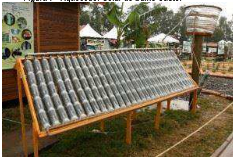
Figura 7 - Aquecedor Solar de Baixo Custo.
