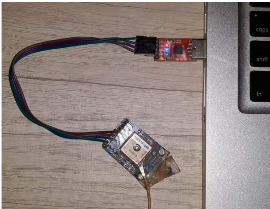
FIGURA 5.13 – CP2102 conectado a USB do PC.
