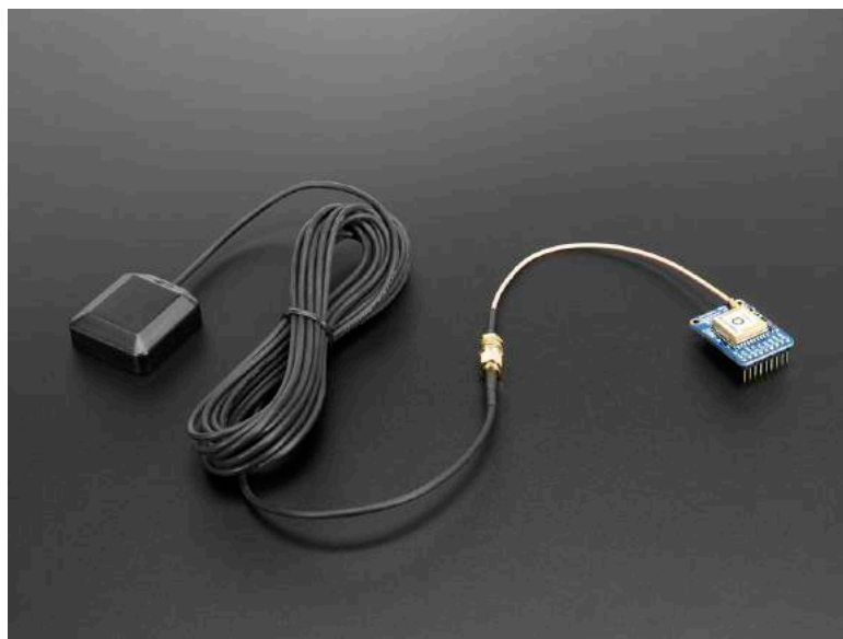
FIGURA 5.20 – Receptor ligado a uma antena GPS automotiva.
