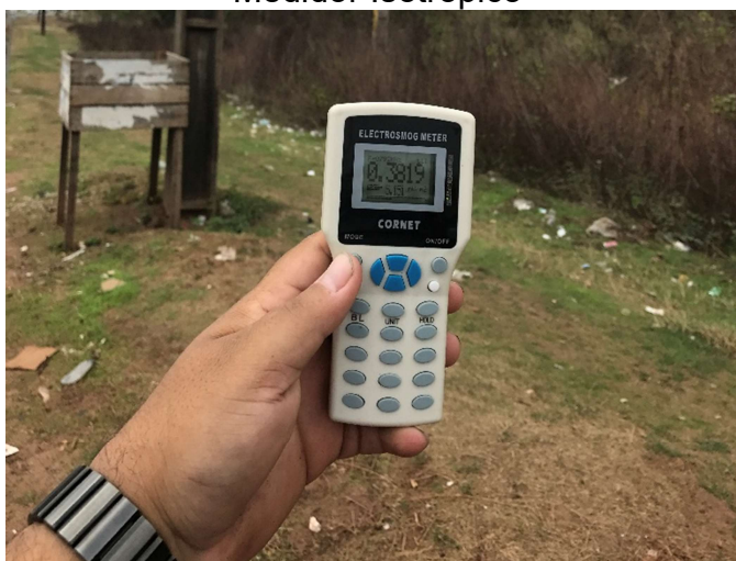
Figura 27 – Medição dos níveis de Densidade de Potência da População Geral com Medidor Isotrópico
