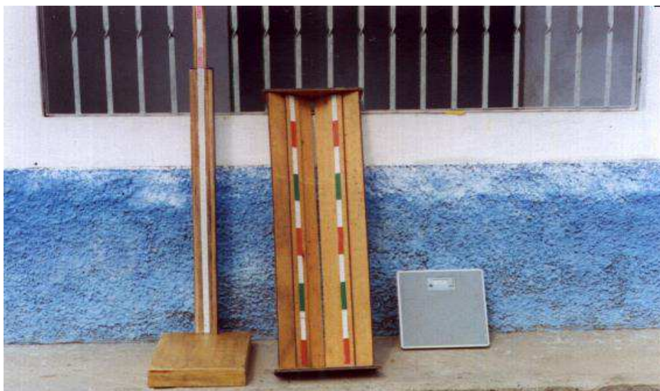
FIGURA 3. Antropômetros e balança usados na coleta de estatura e peso.
