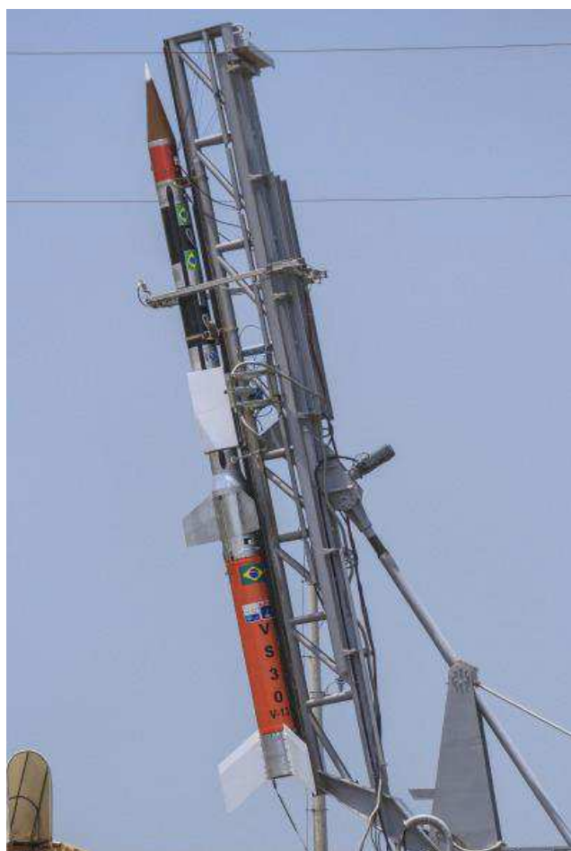
Figura 20.Foguete VSB-30 no trilho de lançamento.
