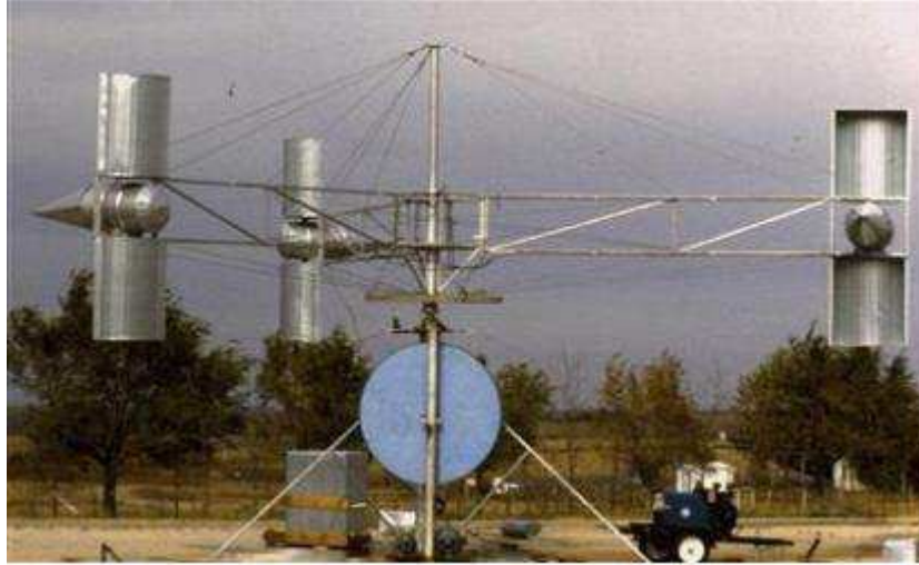
Figura 2.11 – Turbina eólica com mecanismo de arrasto (Adaptado de CLARK, 2013).
