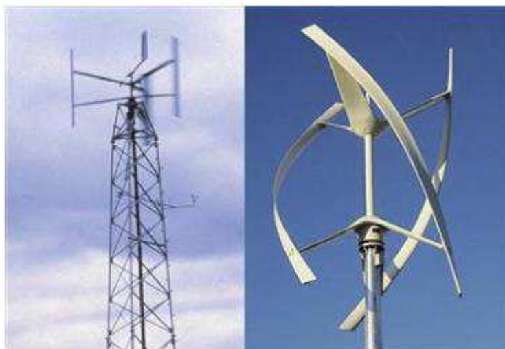
Figura 2.10 – Turbinas eólicas de eixo vertical (Adaptado de CLARK, 2013).
