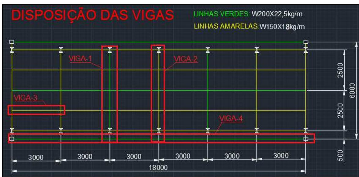
**Figura 3.6: Projeto estrutural da disposição das vigas e pilares, com dimensões na escala cm x cm. (Arquivos do projeto)**
