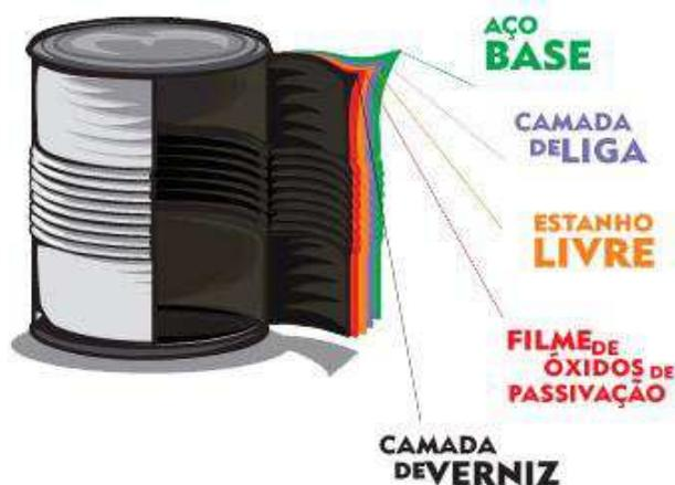
Figura 3.4 - Desenho esquemático das camadas de uma folha-de-flandres (Adaptado de Abeaco, 2012).
