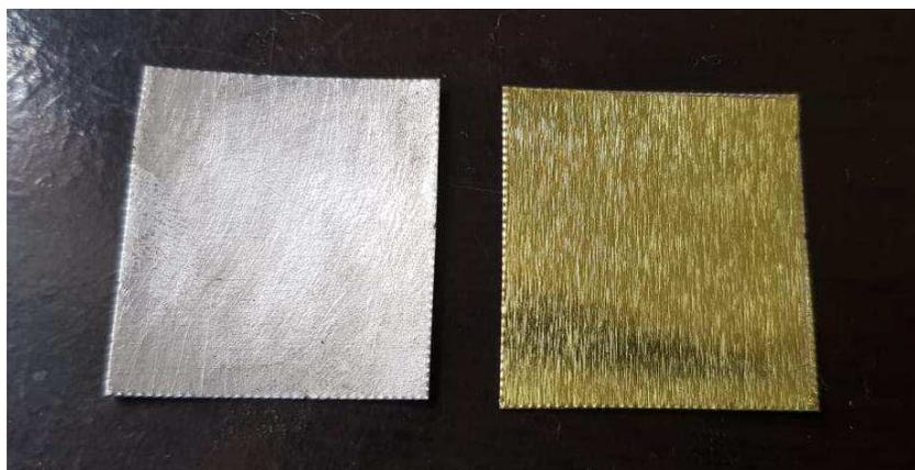
Figura 4.1- Fotografia das amostras: à esq. amostra sem verniz, e à dir. amostra com verniz (Autores).
