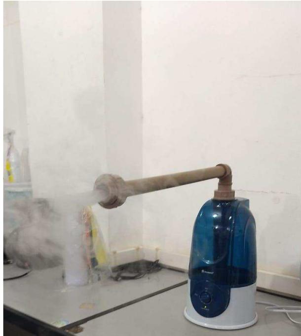
Figura 5.14 - Teste da pulverização do umidificador (Autor, 2019)
