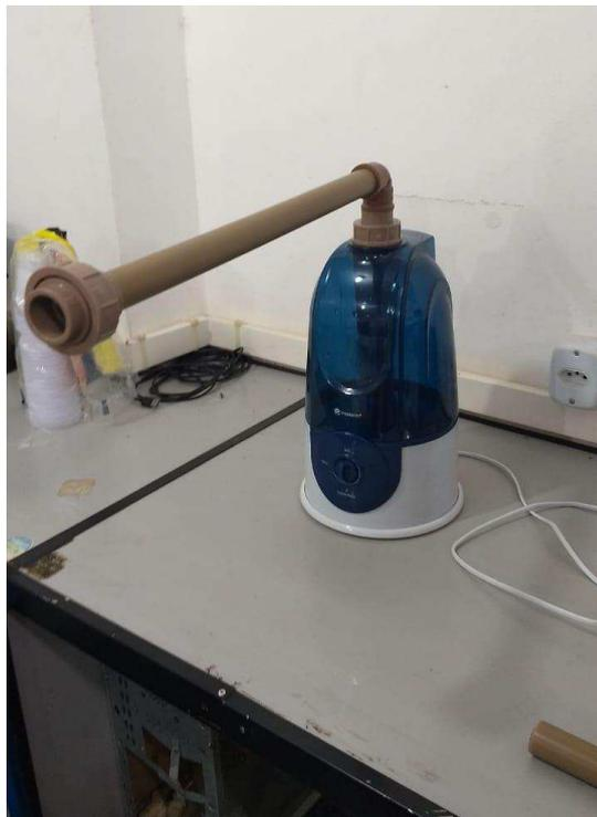
Figura 5.13 - Sistema de pulverização completo (sem solução) (Autor, 2019)
