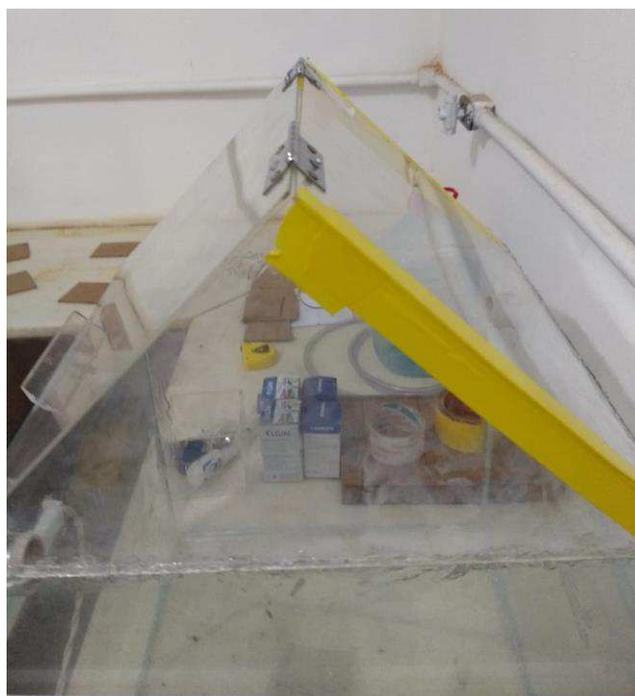
Figura 5.34 - Vedação de parte do teto da câmara (Autor, 2019)
