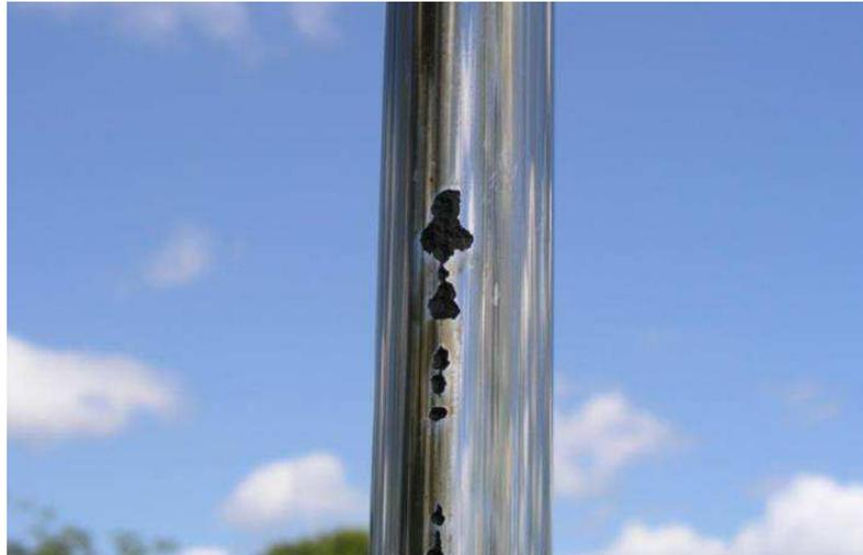
Figura 4.5 - Corrosão por Pites (HALECK, 2016)
