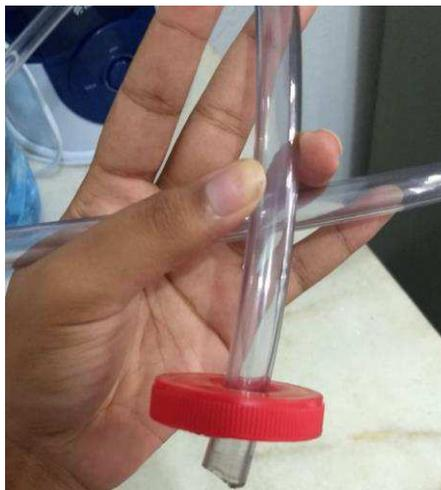
Figura 5.23 - Mangueira para coleta da solução da câmara (Autor, 2019)
