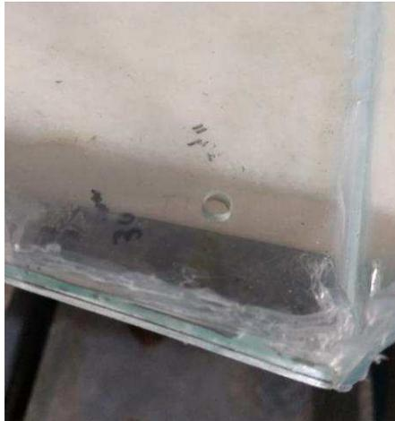
Figura 5.22 – Fundo da câmara furo para saída da solução (Autor, 2019)
