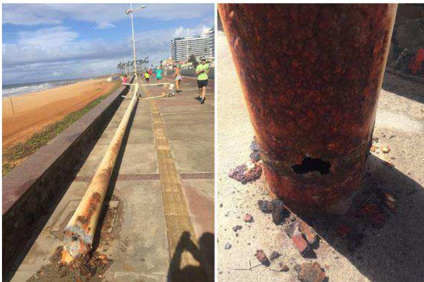
Figura 4.13- Corrosão em postes de concreto (MAIS, 2017)
