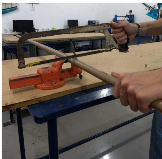
Figura 5.11 - Corte no tubo com serra (Autor, 2019)
