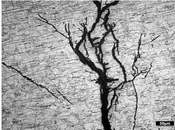
Figura 4.9 - Corrosão Sob Tensão (TORK, 2015)
