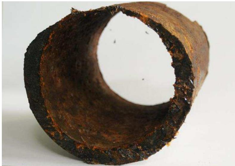
Figura 4.8 - Corrosão por Erosão (GEREMIA, 2016)
