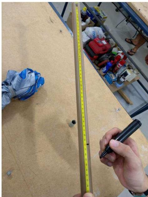
Figura 5.10 - Medição e marcação no tubo PVC (Autor, 2019)
