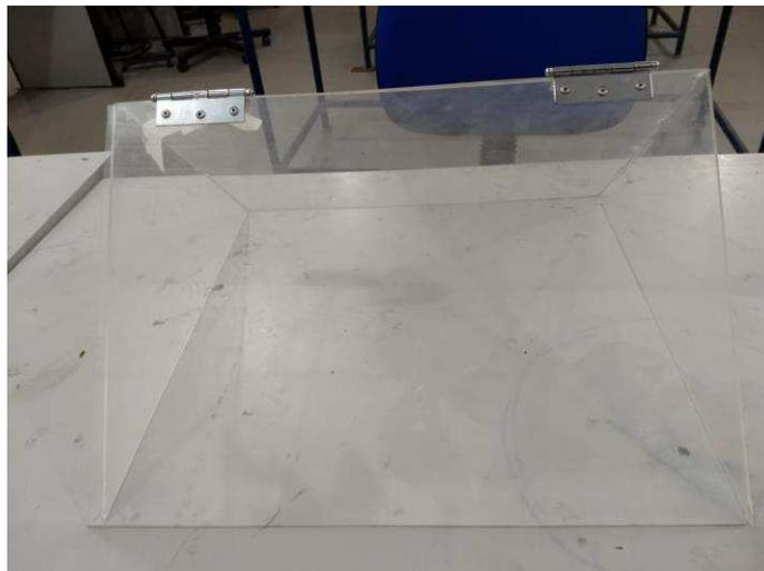
Figura 5.32 - Teto completo, com angulação referente à norma (Autor, 2019)
