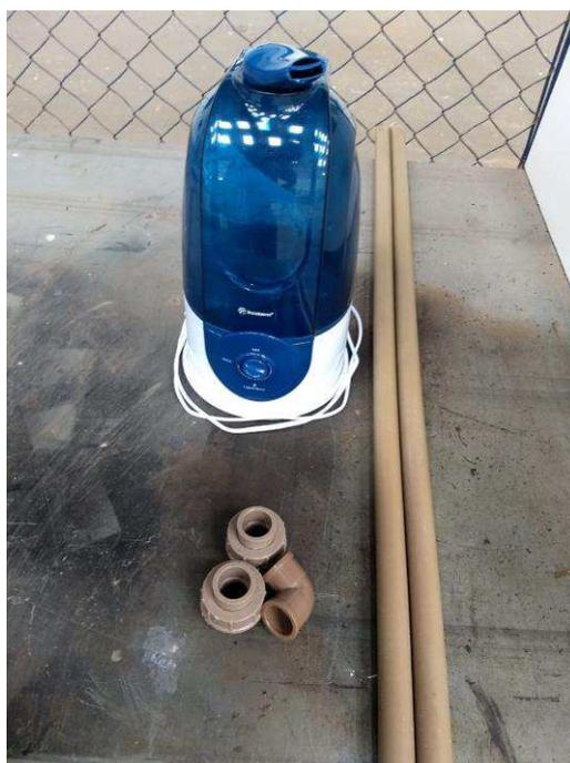
Figura 5.9 - Materiais do sistema de pulverização (Autor, 2019)
