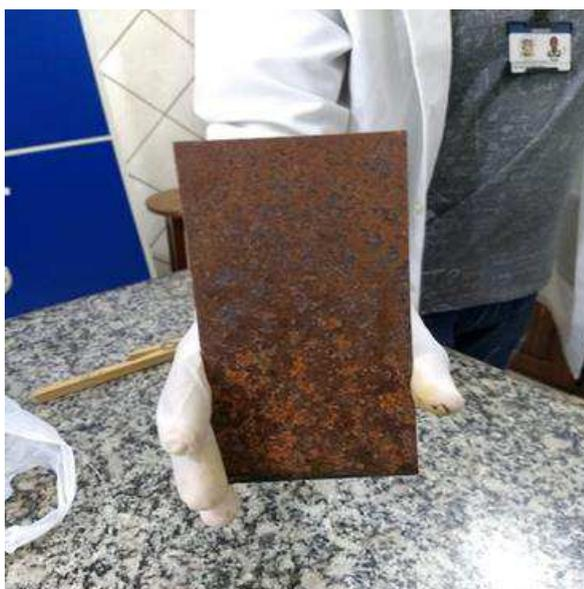
Figura 6.1 - Corpo de prova corroído (Autor, 2019)
