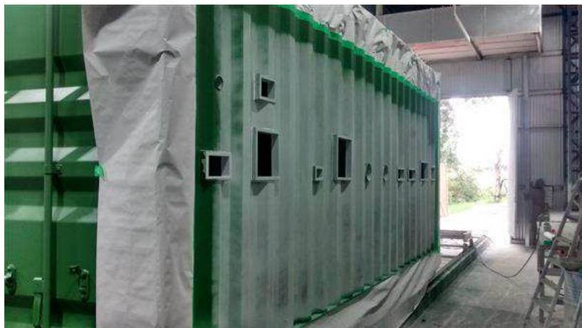
Figura 5.8 – Processo de pintura do container (XAVIER, 2015)
