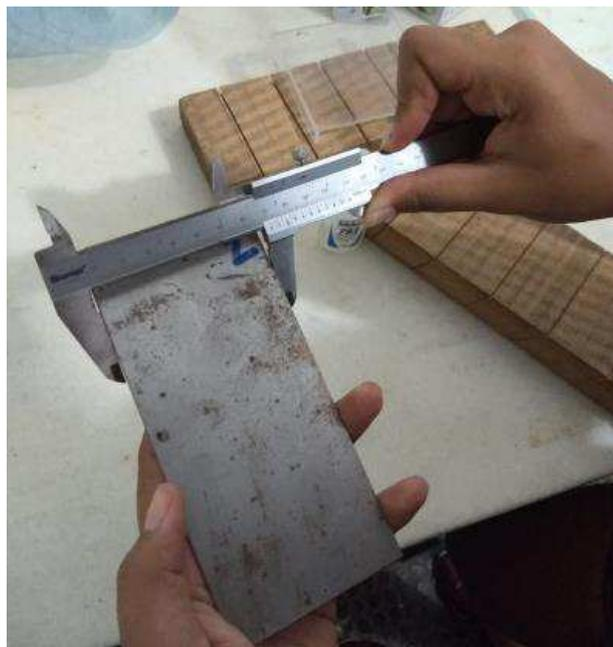
Figura 5.35 - Medição do corpo de prova (Autor, 2019)
