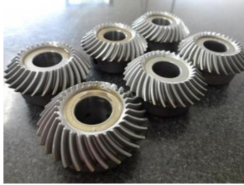
Figura 4.4 - Engrenagens cônicas de dentes helicoidais. Fonte: ANDRADE (2018)
