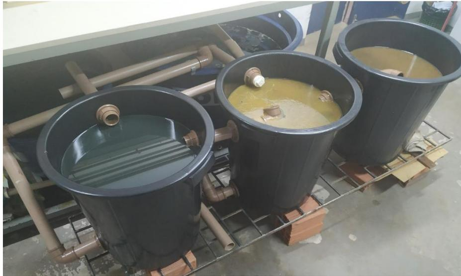
Figura 4-4: Tanques separadores da mistura água-óleo.
