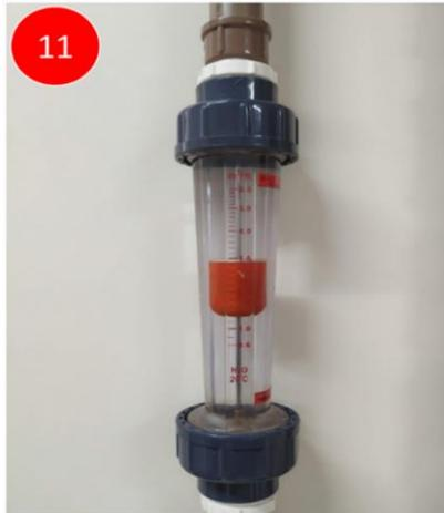
Figura 4-5: Rotômetro analógico.
