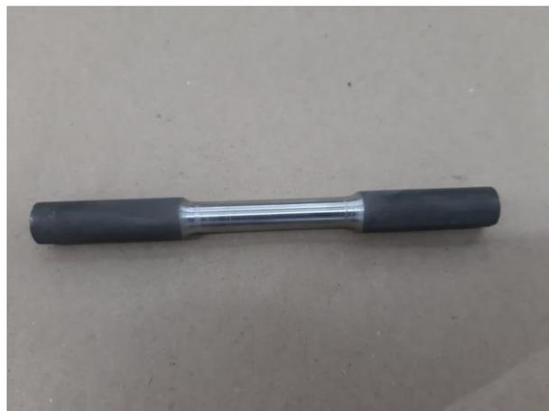
Figura 4.16 - Corpo de prova de tração (Autor)
