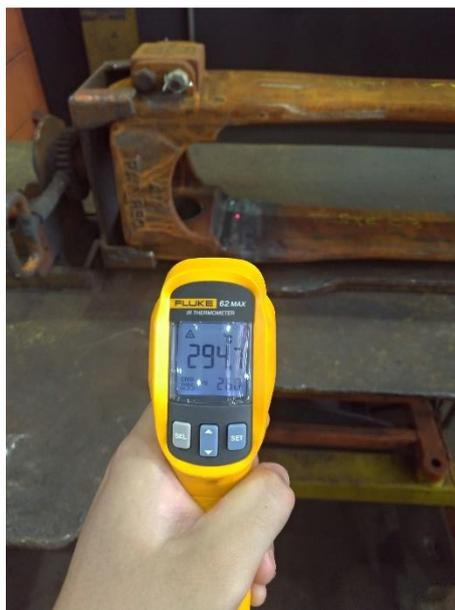
Figura 4.8 - Medição de temperatura após a soldagem (Autor).
