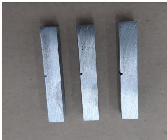
Figura 4.18 - Corpo de prova de impacto (Autor)
