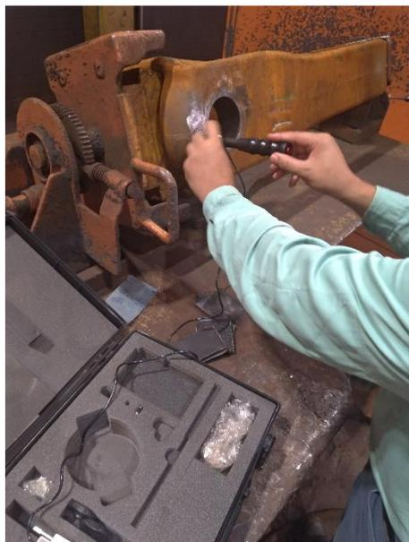
Figura 4.5 - Medição de dureza na braçadeira (Autor)
