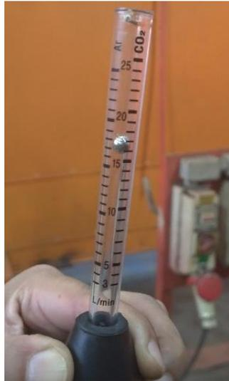
Figura 4.2 - Vazão do gás de proteção (l/min) (Autor)
