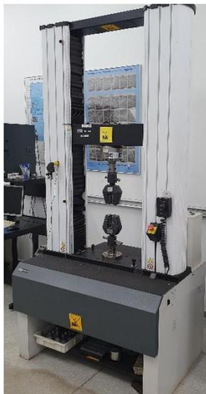
Figura 4.17 – Máquina universal de ensaios mecânicos - Instron 2382 (Autor)
